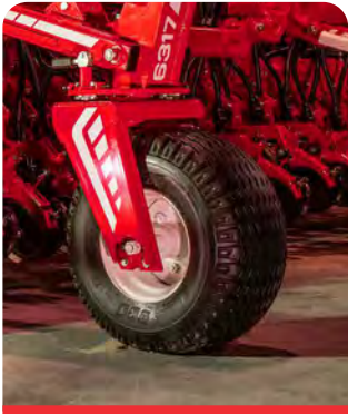
Rodados chasis de siembra 400/60 x 15,5 Presión de inflado 60 Lbs.
