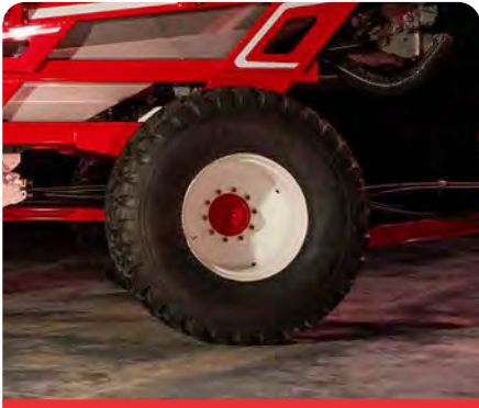
Rodado de carro tolva 750/60-30.5 Alta flotación Presión de inflado 30 Lbs.
